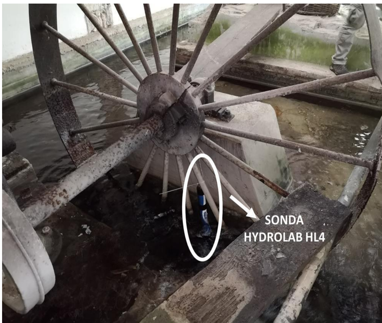
Figura 16. Fotografia della sonda Hydrolab HL4 presso la sorgente di Grassano.
