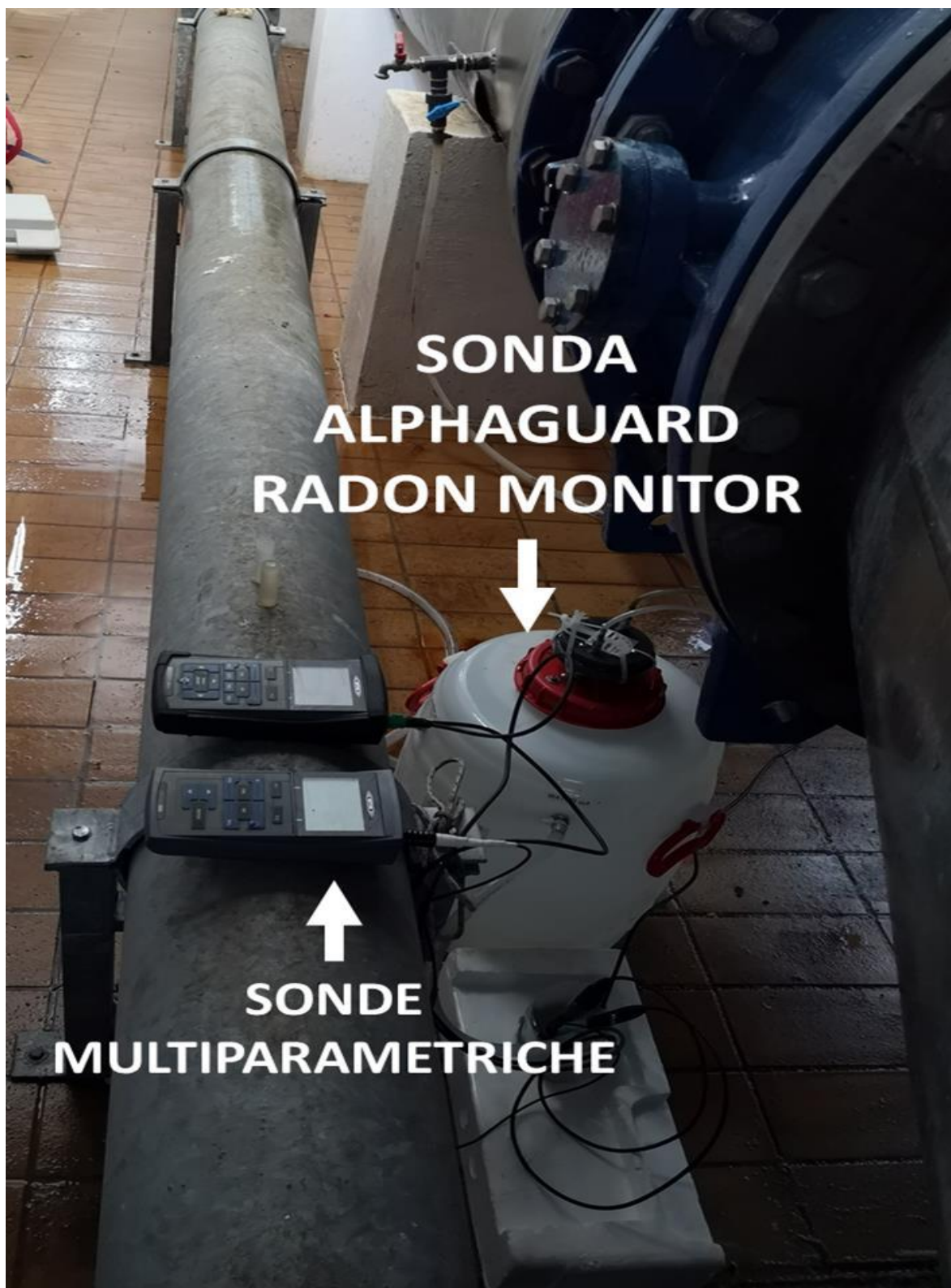
Figura 15. Fotografia della sonda Alphaguard-Radon presso la sorgente di Bojano.
